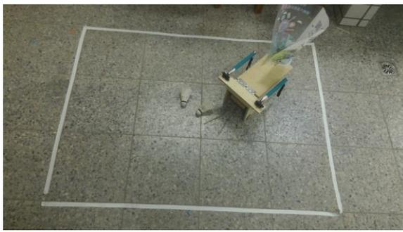
實驗方式：將兩顆羽毛球上編號(1 號、2 號)，並輪流丟至地面長 120cm 寬 90cm 的長方形區塊內(如左圖所示)。利用羽毛檢拾機將羽球撿起。
