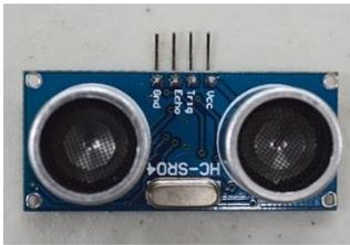
可以提供 Arduino 系統判斷與障礙物的距離，這距離可以是水平距離或是高低距離，也可以偵測物體通過數量(遮斷或在指定距離內判別)
