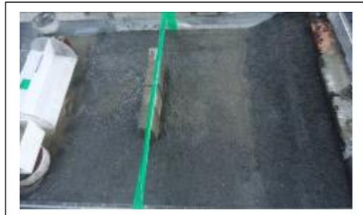
2. 在水槽底部鋪 1 公分的沙，觀察沙灘的侵蝕狀況。
