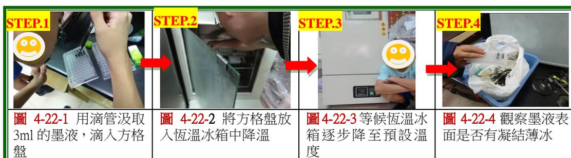
圖 4-22 萃取不同溪石所磨製的墨液，測量結冰時的環境溫度
