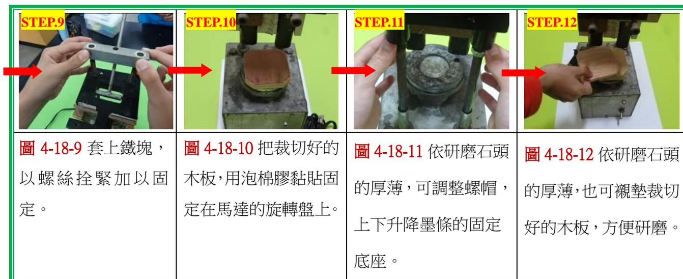
**圖 4-18 自製研磨器的製作與組裝流程**
