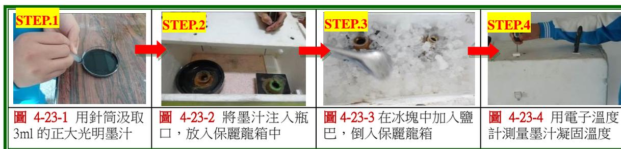
圖 4-23 觀測溪石上正大光明墨汁的凝固點
