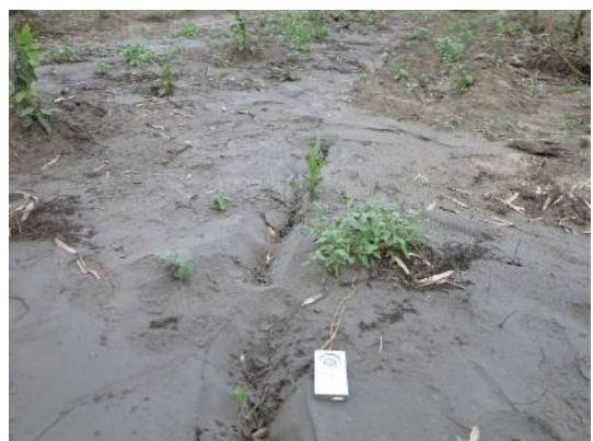
照片 34 山上區石子崎東側一處農田噴砂裂縫量測為 N78^{\circ}E 。
