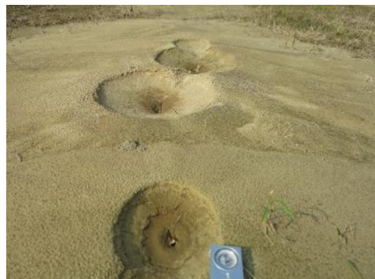
照片 32 新化外環南側一處噴砂裂縫走向為 N16^{\circ}E 。
