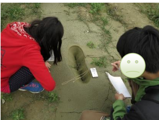
照片 33 大灣東路南側農田的一處噴砂裂縫量測為 N10^{\circ}W 。
