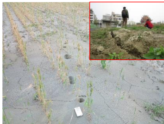
照片 46 南巡宮西南邊填土的麥田出現許多處液化的裂縫及噴砂。
