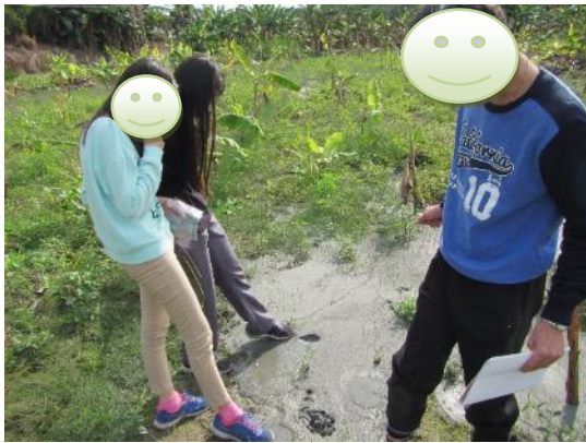
照片 1 山上區石子崎東邊的一處農地發生三塊田的土壤液化。
