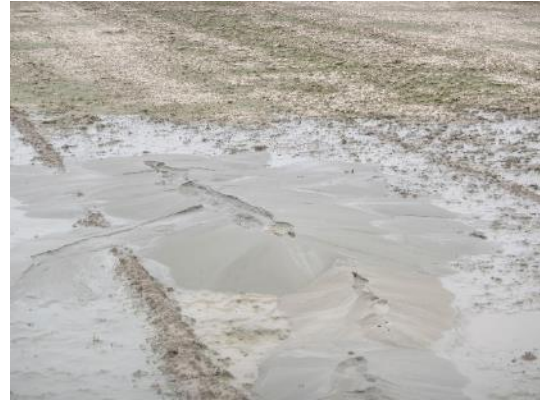
照片 26 北勢里近高鐵的田裡，也噴了兩種顏色的砂，後面大面積的灰色砂是來自比較深層的砂層。
