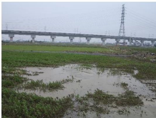
照片 35 北勢里 0206 地震當天測線 C 北段土壤液化噴砂及地下水湧出。
