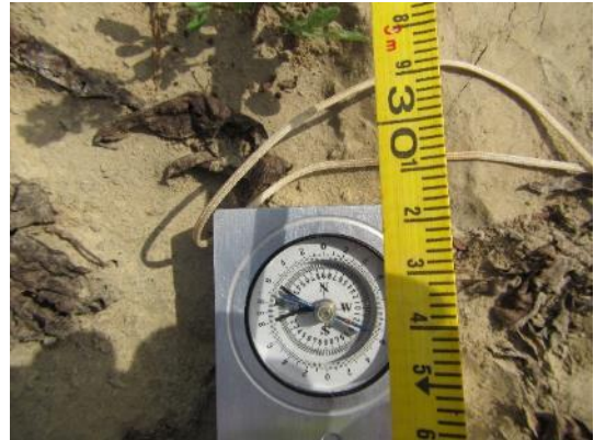
照片 30 北勢里的一處噴砂裂縫走向為 N63^{\circ}E 。
