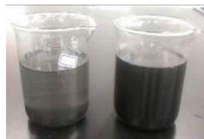
圖 10 石墨粉(左)與石墨烯(右)在水中的差異
