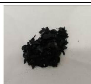
圖 41 幾丁聚醣與氧化石墨烯所合成的氧化石墨烯複合物
