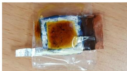
圖(7-6)以海綿吸收電解液正面圖 圖(7-7)以海綿吸收電解液背面圖
