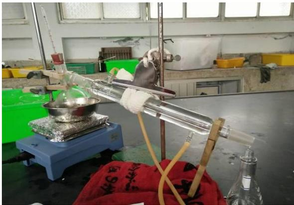
5. 利用蒸餾冷凝裝置，加熱萃取溶液，依序收集待測溶液。
