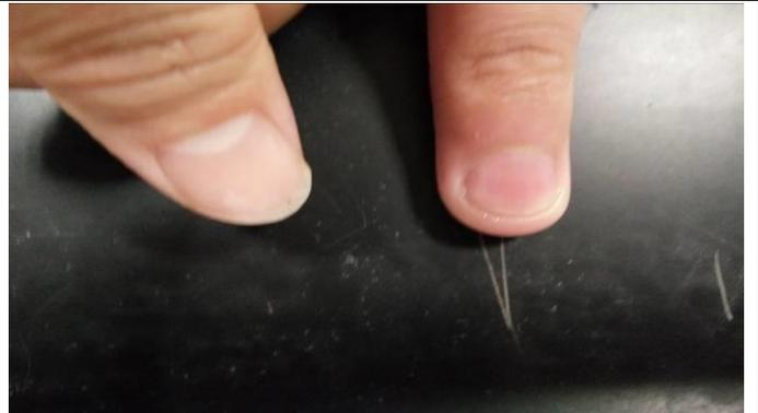
1.水玻璃與果皮萃取酯類溶液混合後塗抹在指甲上，用吹風機吹乾或陰乾
