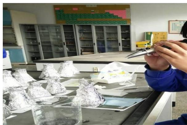
6.折光甜度計檢測不同階段蒸餾溶液甜度數值
