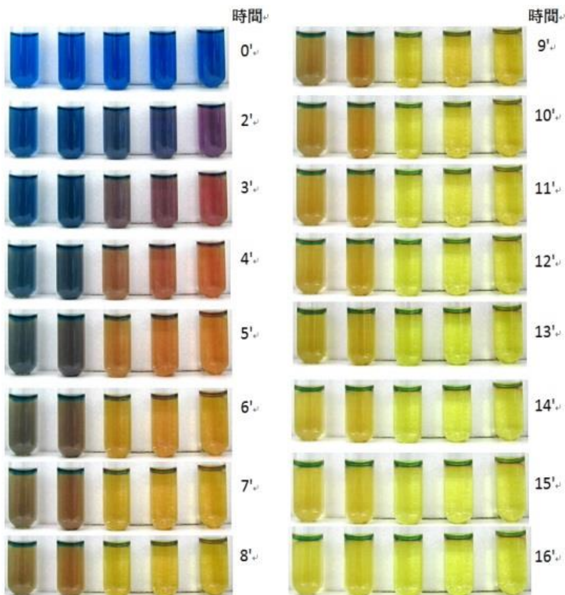
圖 6-23. C100 添加氫氧化鈉還原靛胭脂的顏色變化
