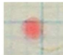
圖 36. 先測量液滴體積，再測量液滴面積，以便算出厚度，用來代表攤開程度。
