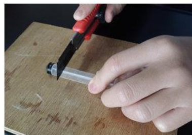
圖 19_a: 測量所需活塞大約的長度 b. 用美工刀切去不要的部分 c. 塑鋼土 AB 膠黏合
