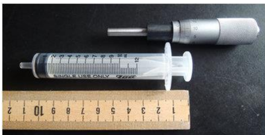
圖 19_a: 測量所需活塞大約的長度 b. 用美工刀切去不要的部分 c. 塑鋼土 AB 膠黏合
