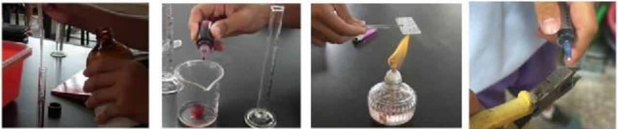
圖 1_a.配製丙二醇溶液 圖 1_b.食用色素染色 圖 1_c.酒精燈烘烤 圖 1_d.夾斷針尖
