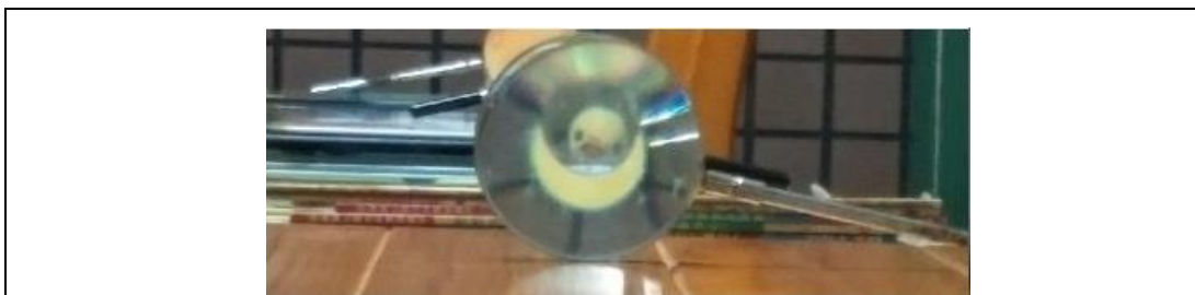
圖十：在離 21cm 透鏡較遠位置(200 cm)處，使用 45 mm 鏡頭進行攝影。
