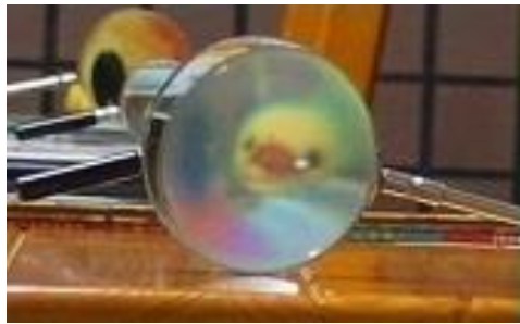
圖十一：離 21cm 透鏡更遠位置(250 cm)處，使用 45 mm 鏡頭進行攝影。
