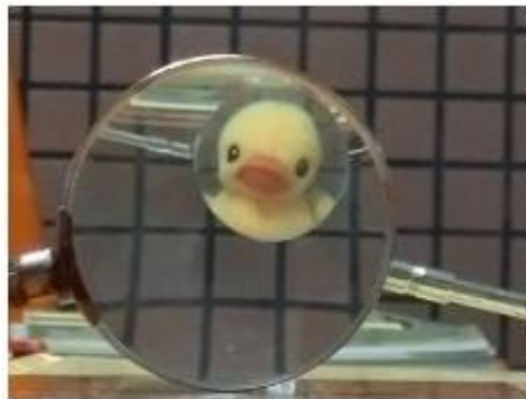
圖七：將 The Rochester Cloak 其大、小透鏡的排列順序，做一個顛倒，所得結果。及讓小透鏡當第一片透鏡，大透鏡當第二片透鏡，反而不易看到第二片透鏡。
