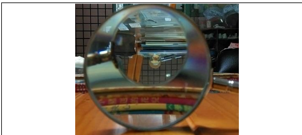
圖八：離 21cm 透鏡較近位置(50 cm)處，使用 22 mm 鏡頭進行攝影。
