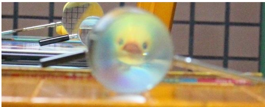
圖十二：離 21cm 透鏡更遠位置(250 cm)處，使用 55 mm 鏡頭進行攝影。
