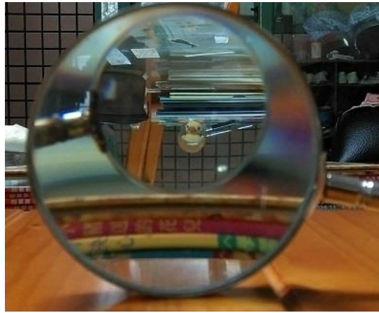
圖六：仿照 The Rochester Cloak 作法，所得結果，目標物在第一片透鏡中，其比例過小。且在讓第一片為大透鏡，使得有太多不必要的雜物入鏡。
