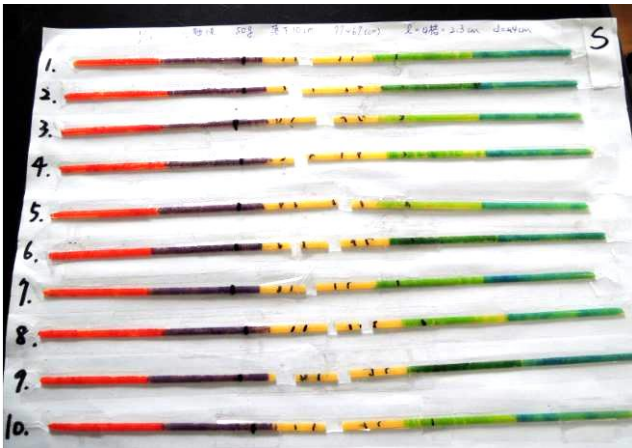
圖二十兩施力點距離 L4，麵條斷裂情況
