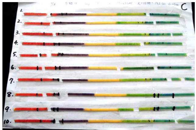
圖二十七 兩施力點距離 L10，麵條斷裂情況
