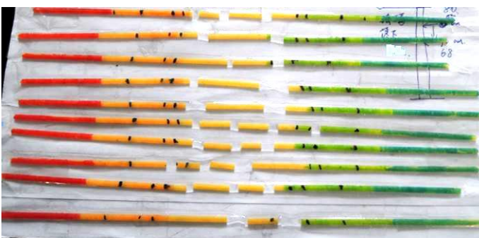
圖十九 砝碼落下 13 cm，麵條的斷裂情況
