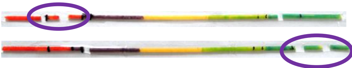
圖三十 斷裂在施力點的情況(紫色圈圈的位置)(L10)
