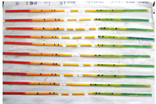
圖二十五 兩施力點距離 L6，麵條斷裂情況
