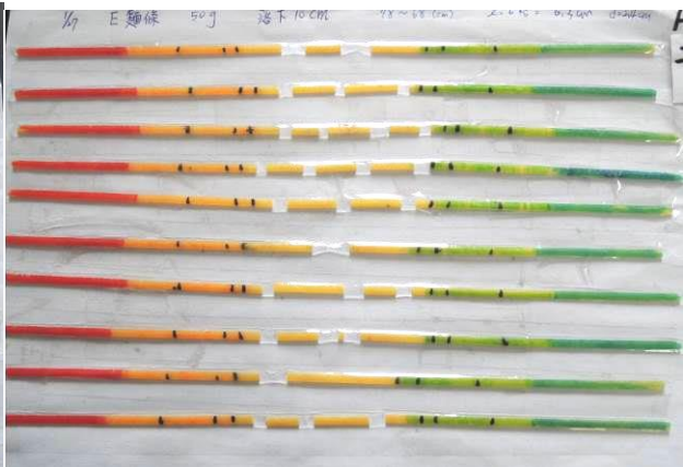
圖十八 砝碼落下 10 cm，麵條的斷裂情況
