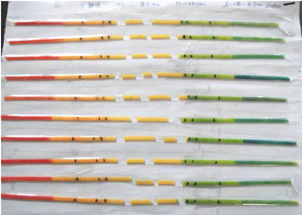
圖十七 砝碼落下 5 cm，麵條的斷裂情況
