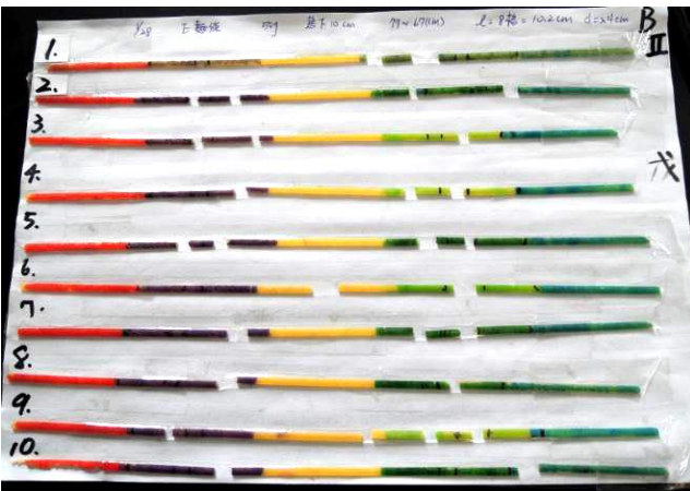
圖二十六 兩施力點距離 L8，麵條斷裂情況
