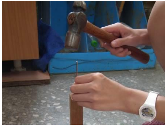
圖五 用鐵鎚將金屬棒敲入木條中
