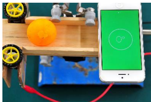
圖 4 利用手機的水平儀進行校正
