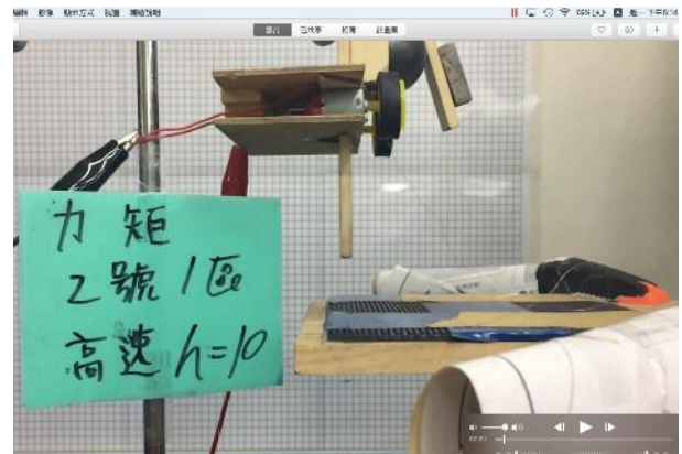
圖 20 測試拍面貼於一端固定木板上，高速球入射最遠端
