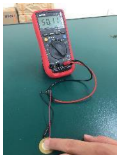
圖 12 壓電片接上橋式整流器整流
