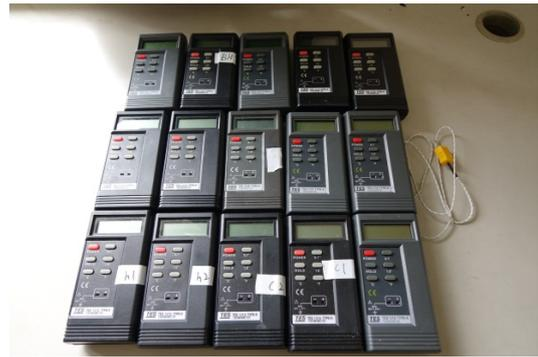
圖 2:熱電偶溫度計
