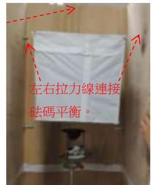
左右拉力線連接法碼平衡。
