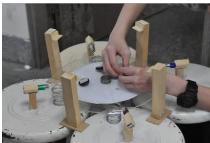
彈簧、測試板與雷射光源
