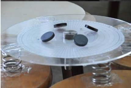
測震板感應震動 支撐彈簧放大震動 外圍磁鐵擺動反應震動
