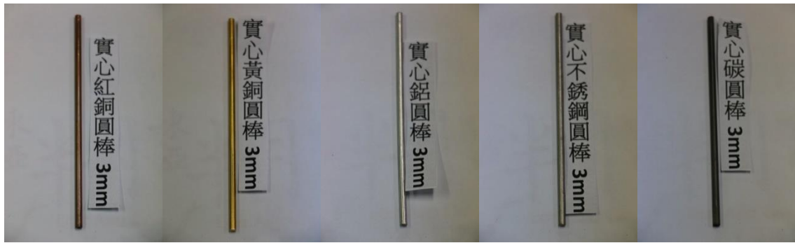
圖 9 直徑相同不同材質的避雷針
