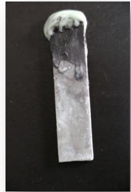
圖 19 以硫酸銅澱粉溶液電鍍的產物
