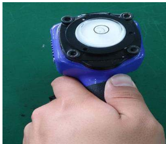
圖二十五、將水平儀平貼在釘槍後蓋上
