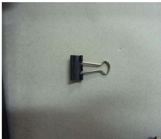
圖十九、選擇適合尺寸的長尾夾做安全卡榫
