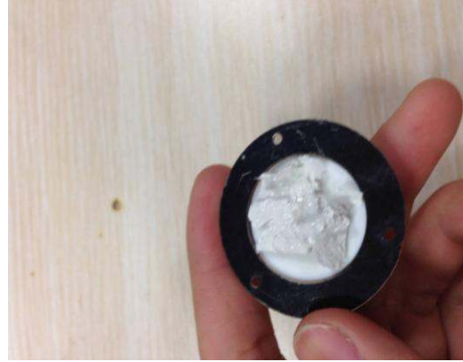
圖二十四、AB塑鋼土塗抹水平儀
