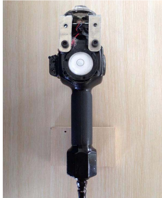
圖十八、釘槍正側水平儀安裝位置
