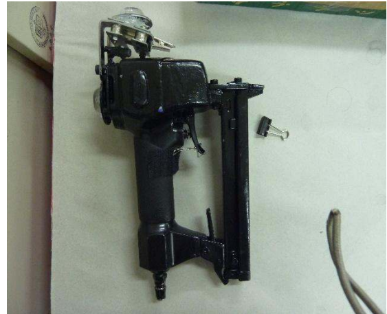
圖二十、安全卡榫安裝過程
