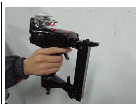
圖三十五、雷射水平儀校正釘槍
