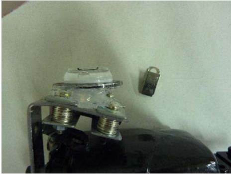
圖十一、利用鱷魚夾改造雷射光投影裝置
