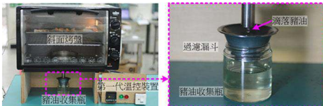
圖 17 第一代集油裝置收集豬油之測試
