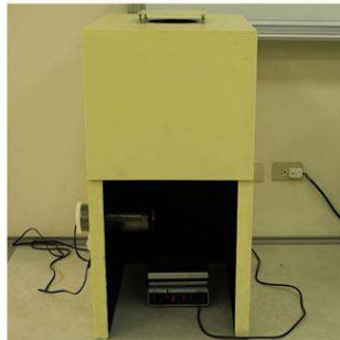
自製發煙點測定裝置 (A. O. C. S. 之規格)
