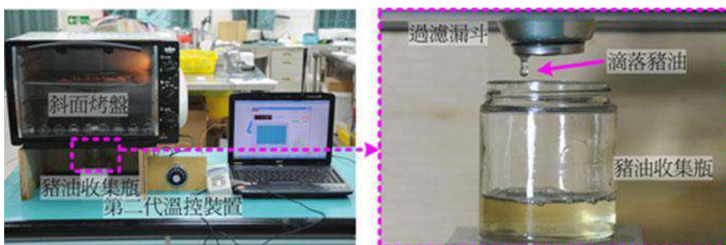
圖 22 第二代集油裝置收集豬油之測試
