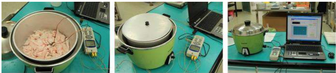
A. 將豬脂肪組織及水放入內鍋 B. 使用熱電藕測試溫度值 C. 連接電腦軟體紀錄溫度變化
