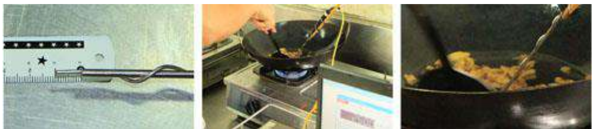
A. 使熱電藕不直接接觸到炒鍋 B. 使用熱電藕測試溫度值 C. 豬油粕炸至金黃色停止加熱
