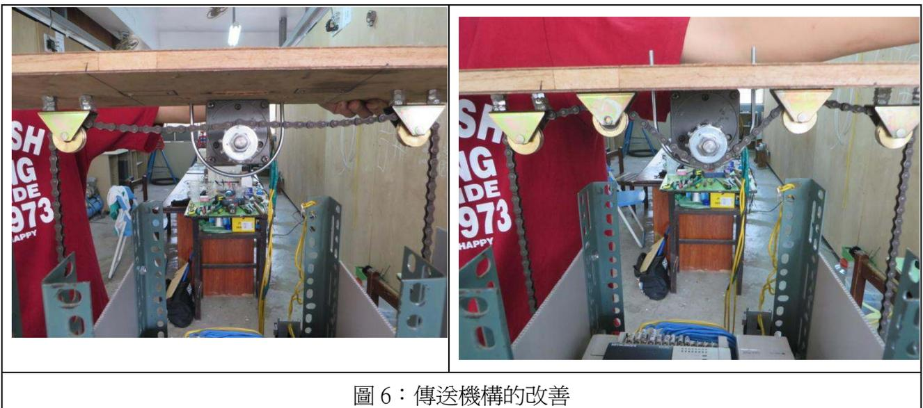
在實驗的過程中，載重箱因為實驗的載重不同時，容易產生搖晃，造成箱體不穩定，經過我們小組設計，輔助載重箱運動的軌道，讓載重箱可以在軌道中穩定的上升與下降。
