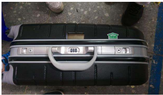
旅行箱拆出小洞讓 LCD 螢幕能夠顯示在外面
