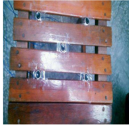
圖(七) 安裝五個壓力開關的課桌椅
