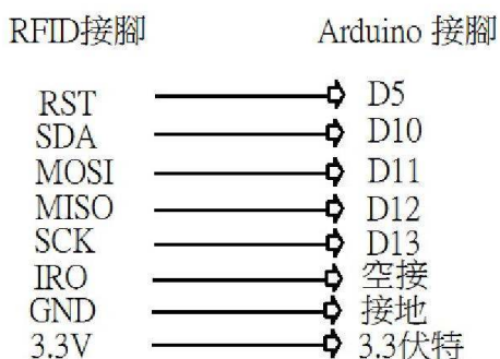
圖(十六) RFID 模組與 Arduino 微控制器之接腳連線圖
