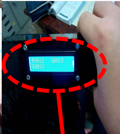
髮色偵測中數值顯示於 LCD 上
