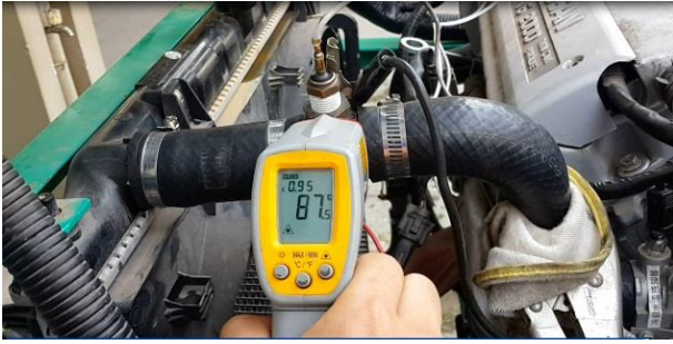
圖 13 水箱內部堵塞
