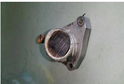
圖 8 節溫器卡死關閉位置故障
