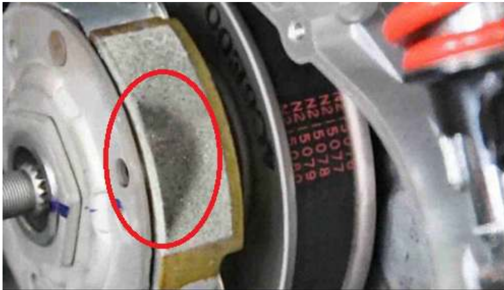
圖(6)示意圖紅色處 離合器蹄片磨損部分
