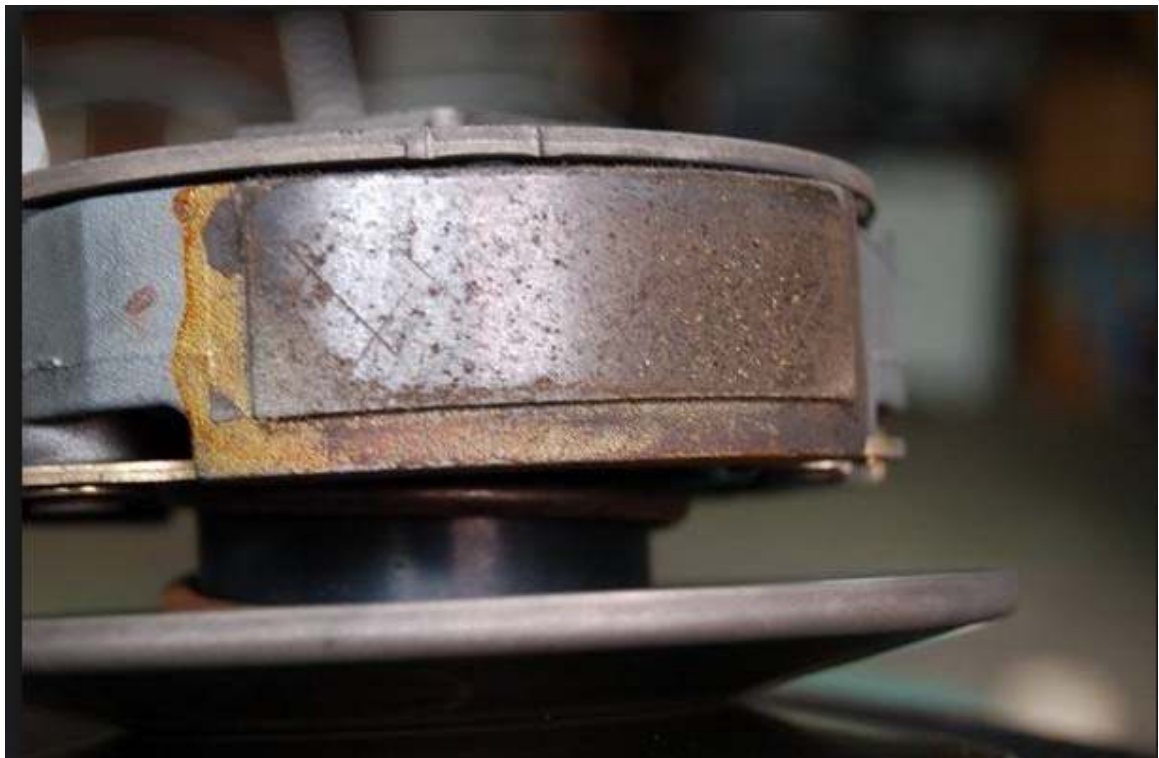
圖(19)因為蹄片磨耗完全而須整組更換的離合器
