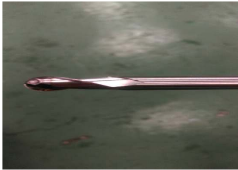
圖(15)高速鋼(HSS)刀頭部有點磨損
