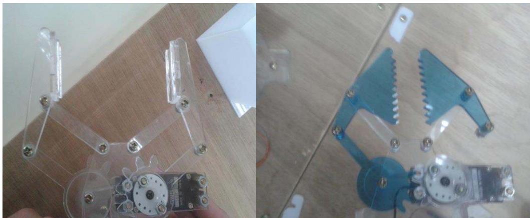
圖 4-6 夾爪樣式比較 第一版(右)第二版(左)
