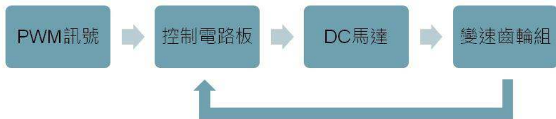
圖 3-12 伺服馬達動作原理
