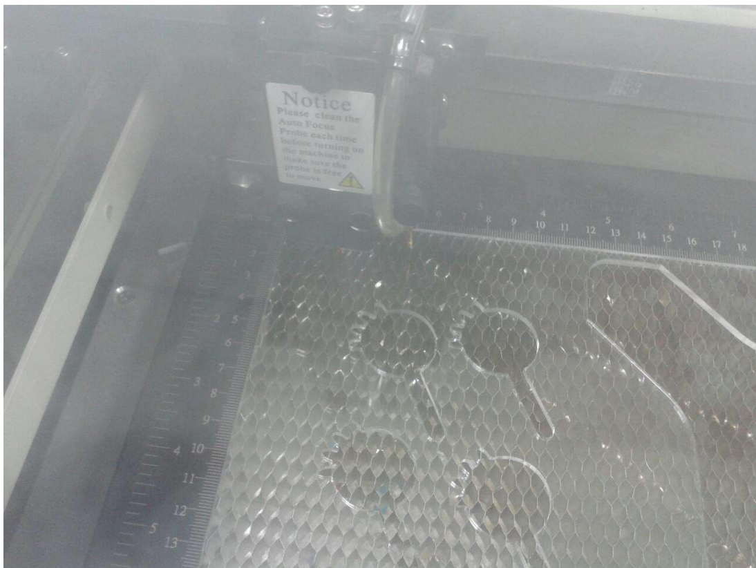
圖 3-4 雷射切割進行過程圖
