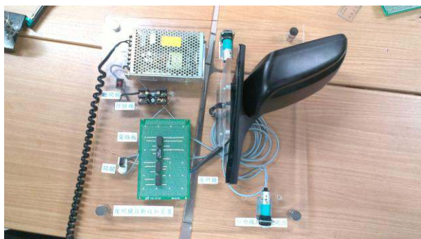
圖 25-3 物體遠離後照鏡由手動開關將照鏡開啟
