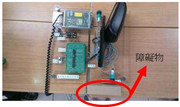
圖 25-2 物體進入前方感測範圍時後照鏡自動收折
