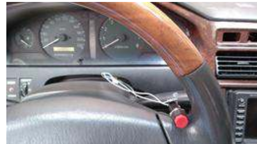
圖 23-6 後照鏡開啟手動開關安裝
