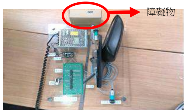
圖 25-1 物體進入後方感測範圍時後照鏡自動收折
