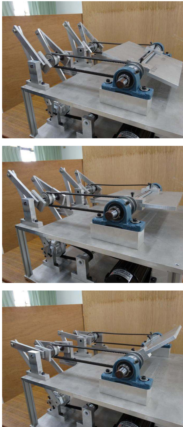
圖 28 踏板操作功能 (上)上死點位置 (中)對稱點位置 (下)下死點位置
