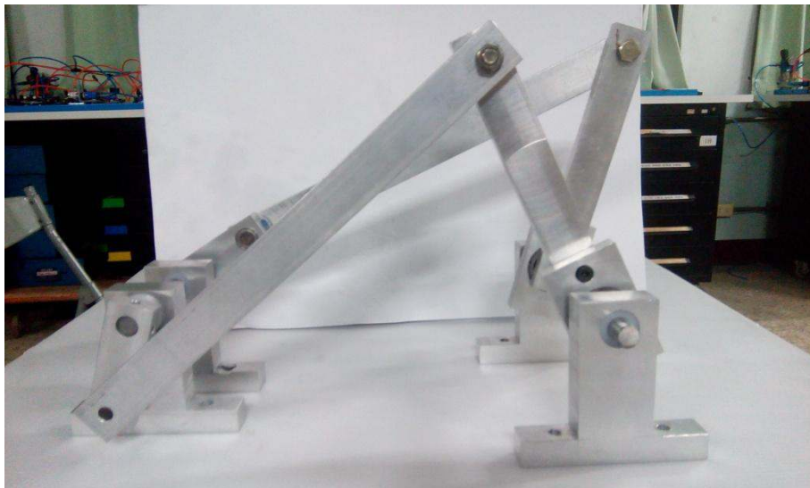
圖 23 搖桿曲柄四連桿驅動機構組裝
