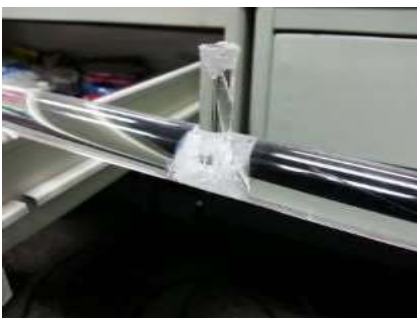
圖 23 結合內部斷裂
