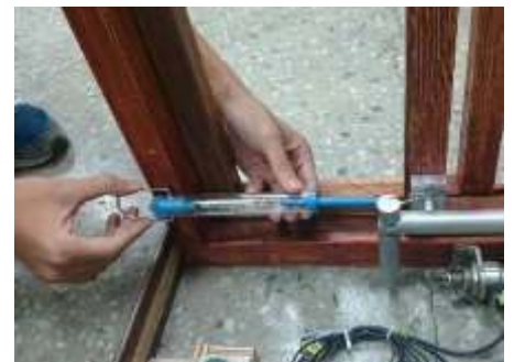
圖 7 利用力量計計算施力。
