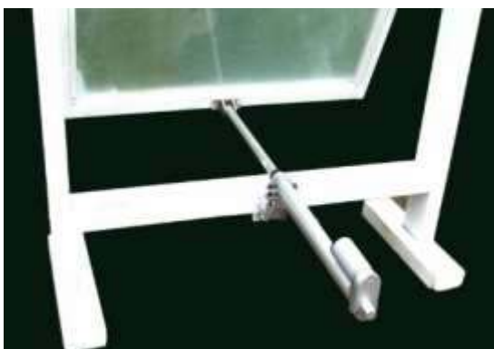
圖2 利用螺桿式馬達自動開窗。
