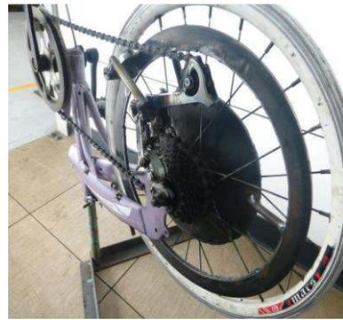
圖 7 裝有離心變速機構之腳踏車
