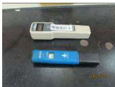
圖[5-6] 為硬度計及導電度計
