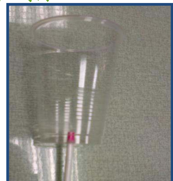
將聚酯纖維棒之一端塞入塑膠杯中，使塞入部分長度為 1cm(圖中紅色部分)。
