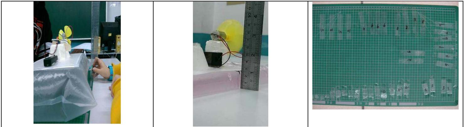
測量柔裙充氣後的最大高度
