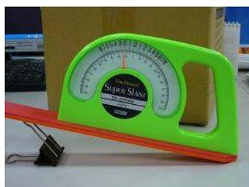
圖 7 傾斜角度儀
