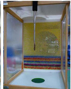
圖 21 測量一代風洞
