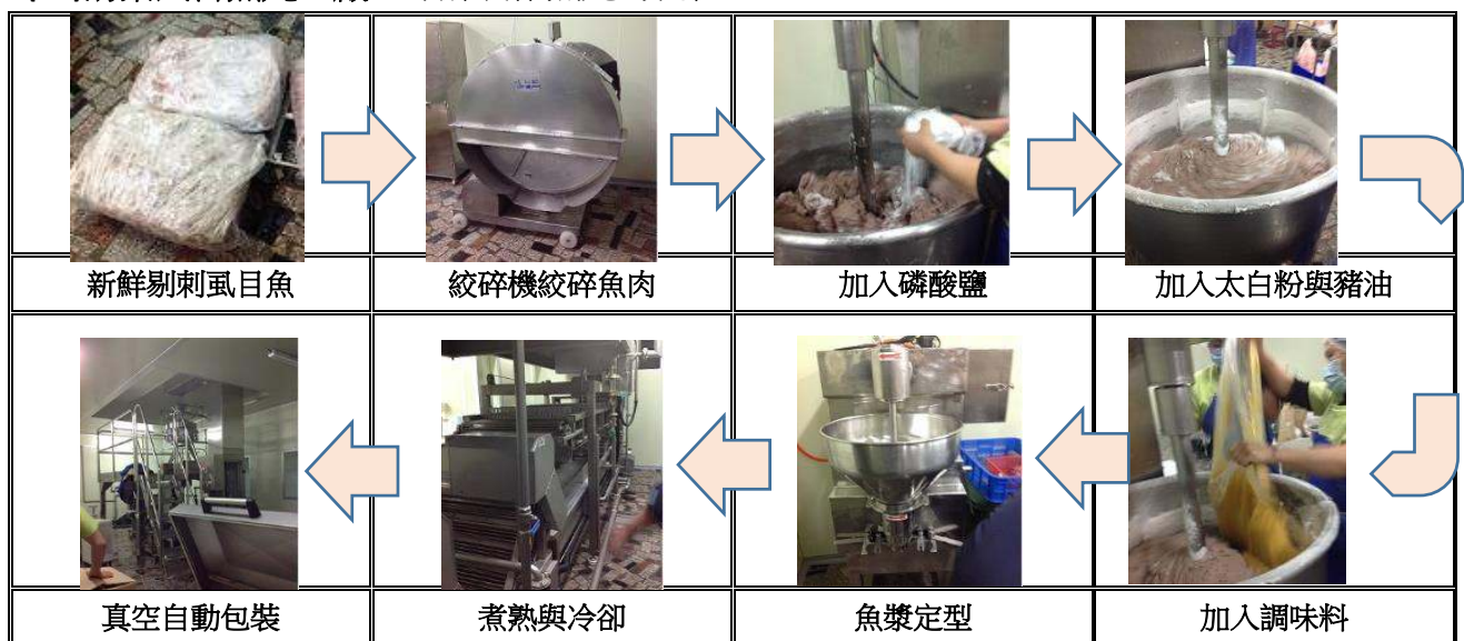
照片 4-2 虱目魚丸工廠製丸流程
