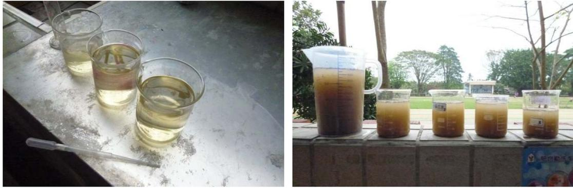
圖 17 左方「分層堆疊」透水較清澈，右方「混合堆疊」透水較混濁
