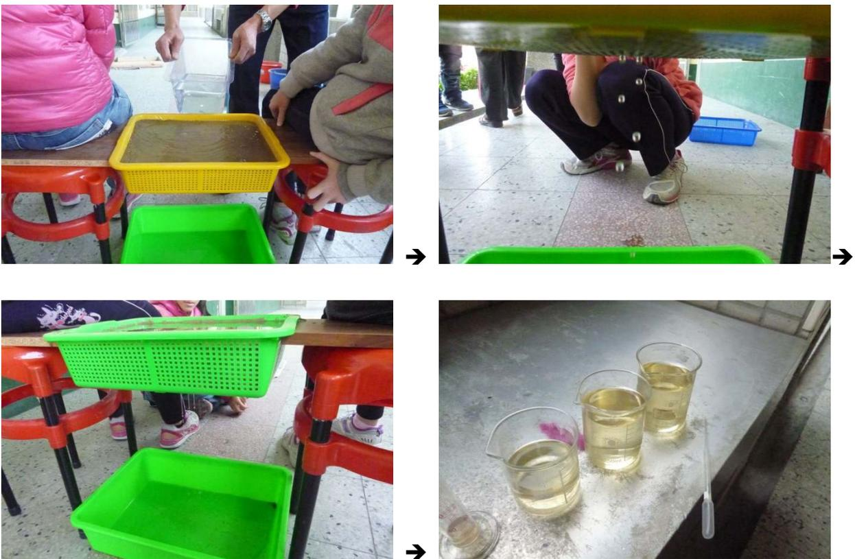
圖 6 倒水計算出水時間以及測量 5 分鐘透水量流程圖
