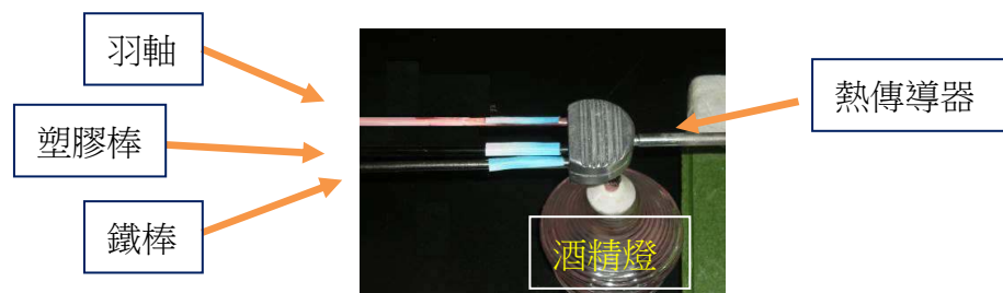
圖 4 羽軸傳熱實驗
