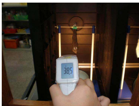
圖 9 紅外線溫度計的雷射點對準測試物
