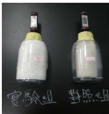
圖 14 絨羽保暖實驗裝置的實驗組和對照組
