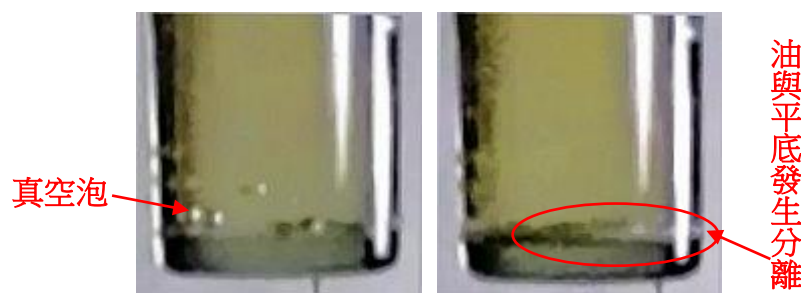
圖二十：裝有食用油的玻璃瓶底所發生的現象
