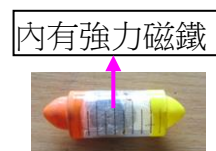
圖十六：自製壓力變化觀測器
