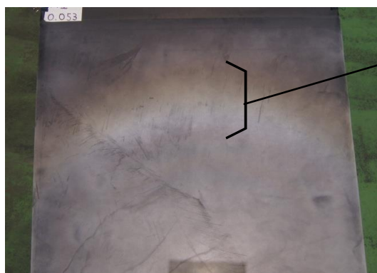
圖三-2：利用玻璃珠製造出霧虹(0.053mm)。
