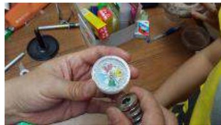
二、磁鐵磁極問題。因為我們做小型風力發電，所實作發電盤中磁鐵排列相當靠近，因此會有磁力線互相吸引的問題，例如下圖左邊所示，當發電盤的磁鐵都是同一磁極面向外（我們將N極面向漆包線圈），則因磁鐵“同極相斥”造成磁力線垂直射出的高度比較高。若是讓N極-S極交互的排列在發電盤上，則因為“異極相吸”造成N極磁力線過早彎曲到鄰近S極磁鐵上，如此則通過漆包線圈的磁力線數目就會減少，造成發電效率不佳。
