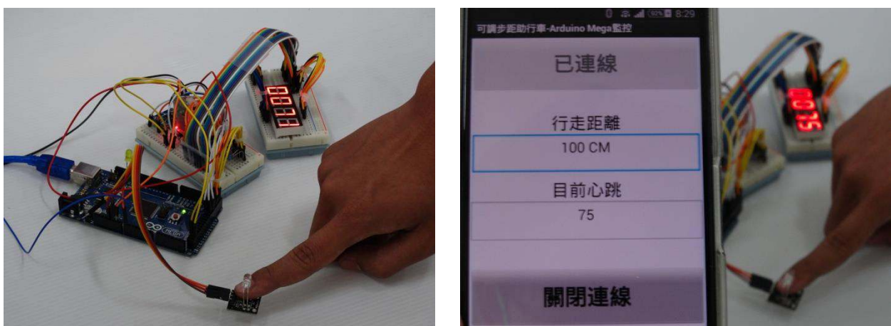
圖 41 心跳體徵顯示 (左)七段顯示器 (右)智慧型手機
