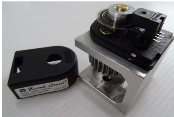
圖 19 由光編碼器組成之測距機構
