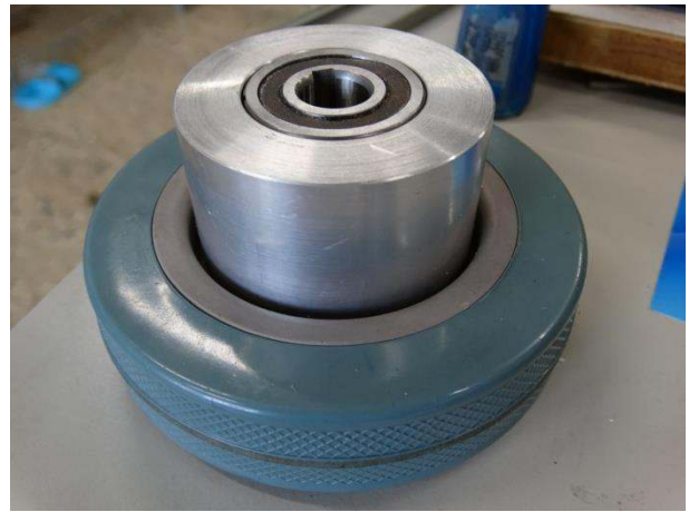
圖 34 後輪止逆機構
