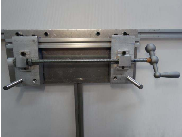
圖 28 操作把手行程調整機構
