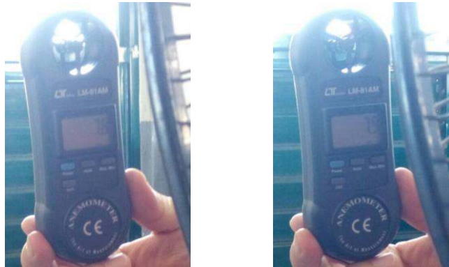
圖 14 風速測試達到每秒 7.6 公尺、每秒 7.9 公尺
