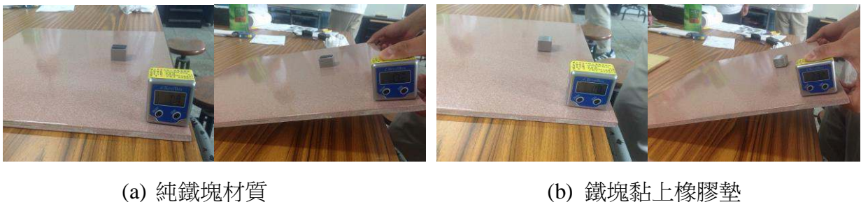
圖 7 靜止角試驗 — 在磁磚地板之接觸摩擦
