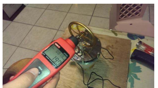
5、每隔1分鐘紀錄1次引擎上部、底部的溫度及轉速，直到停止轉動為止
