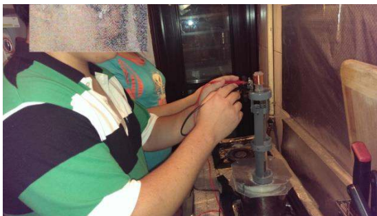
3、測量發電機的發電量
