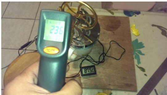
5、每隔1分鐘紀錄1次引擎上部、底部的溫度及轉速，直到停止轉動為止
