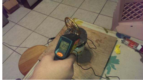
2、測量引擎上部溫度
