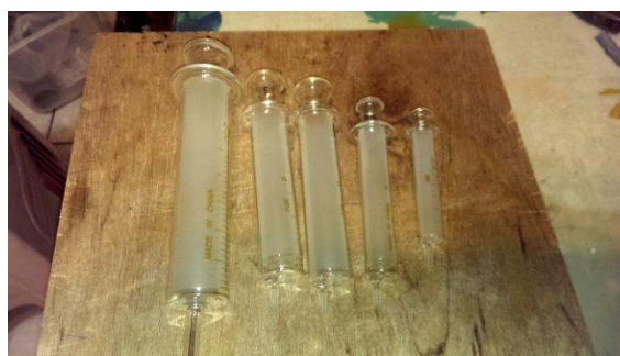
以玻璃注射器製作汽缸，活塞，中央軸
