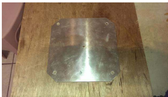
完成冷、熱腔上、下底板
