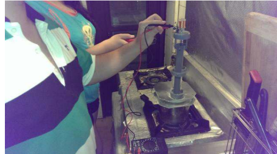
3、測量發電機的發電量
