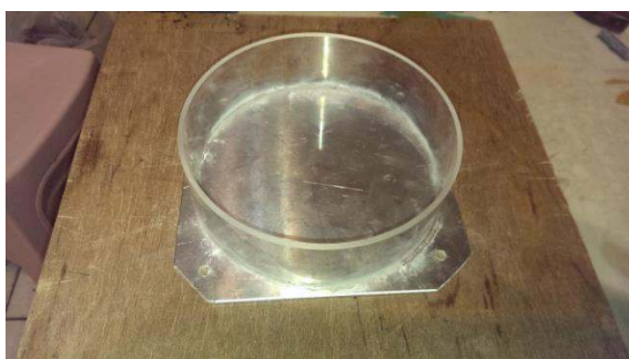
以透明壓克力製作冷、熱腔體
