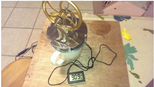
3、將引擎置於溫度約90°C之熱水上
