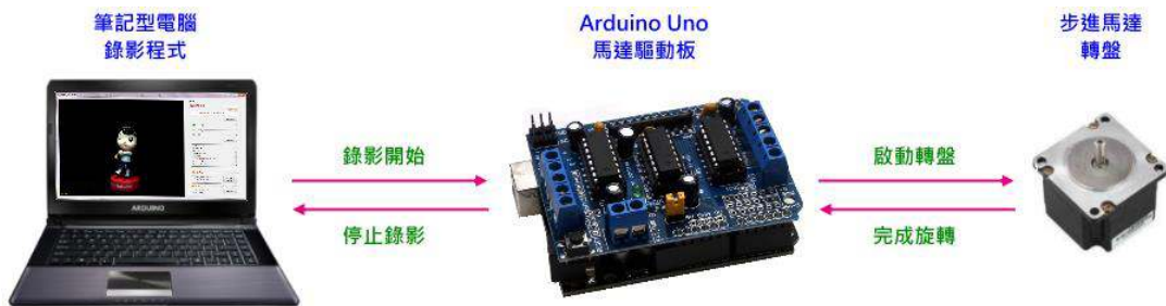
圖 14 錄影程式與轉盤的溝通運作模式示意圖
