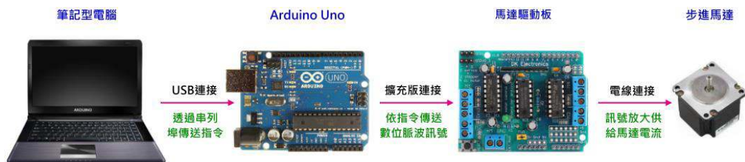
圖 12 步進馬達轉動的控制流程
