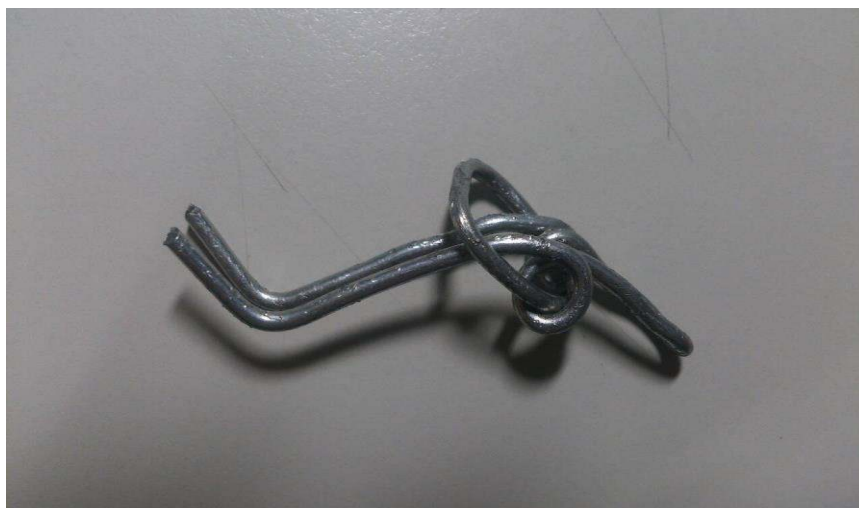
【圖 11】以鐵絲為材料，製作模型類似裝置的骨架，簡單模擬筆蓋的結構。
