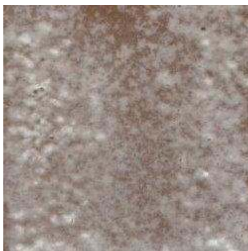
圖 8 釉面雖熔融，但不均勻的燒成釉面狀況
