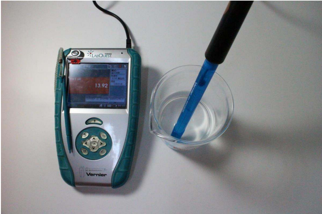
圖 10 測試氫氧化鈉水溶液之 pH 值
