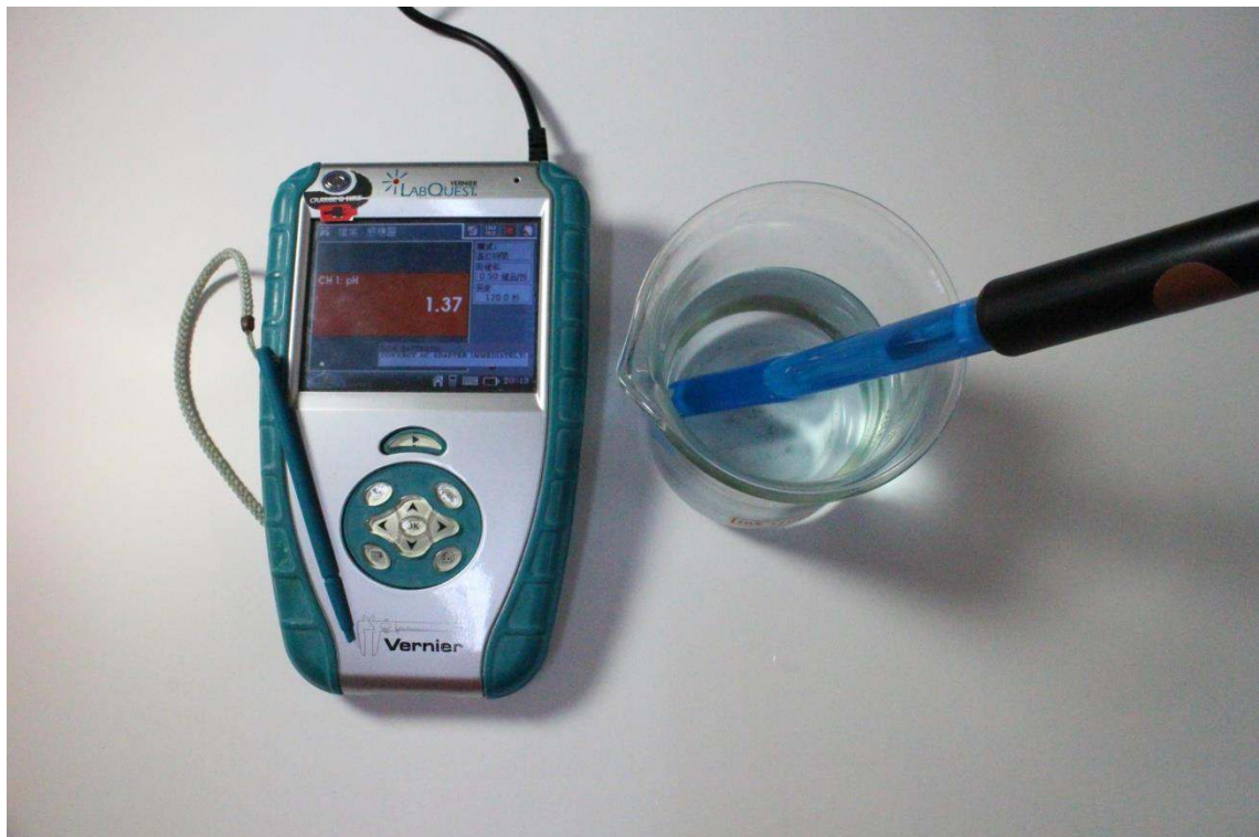
圖 11 測試氯化氫水溶液之 pH 值
