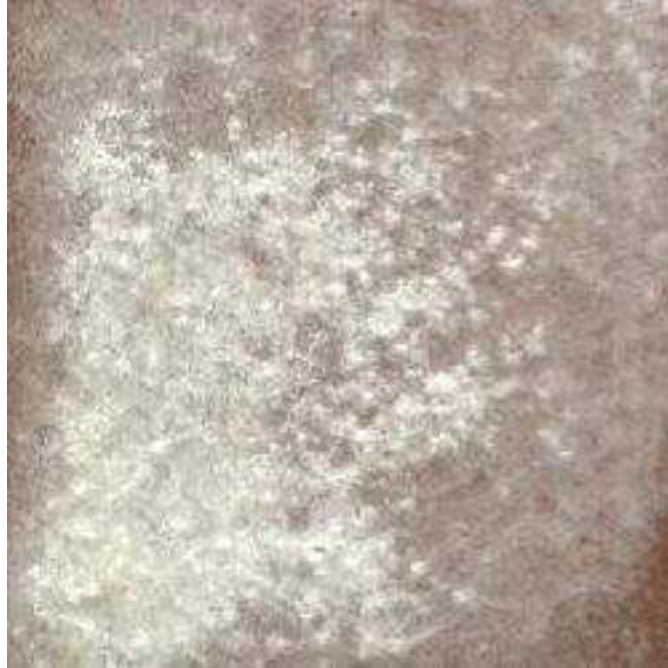
圖 7 牡蠣殼粉 30%和霞正長石 70%混合之釉藥燒成結果(1140°C)
