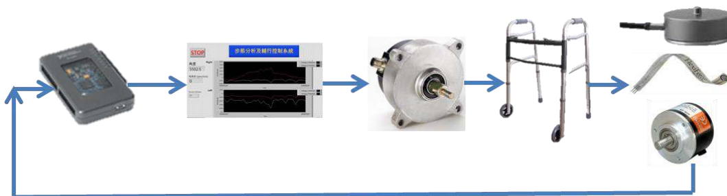
圖 23 可控式輔行設備之控制流程圖
