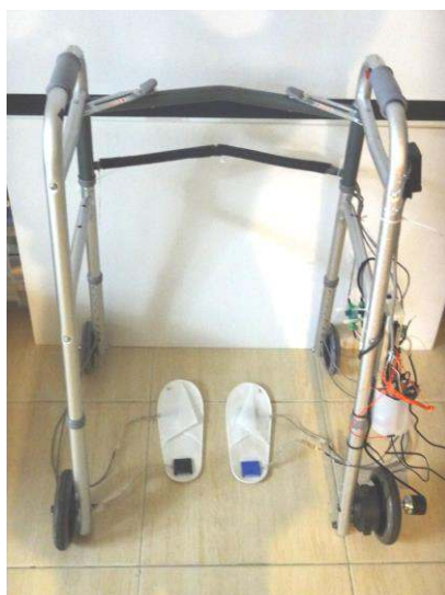
圖 9 安裝 MR 煞車器及各式感測器的第一代可控式輔行設備
