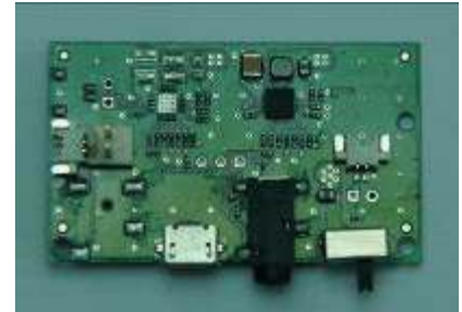
圖 3、驅動電源電路板
