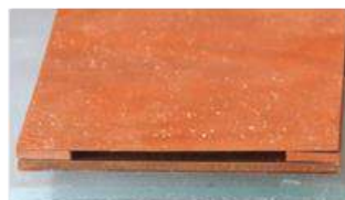
圖 79,80、1mm(上)與 2mm(下)夾層高度設計
