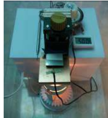
圖 21,22、矩形壓電葉扇 (左：間距 0.50cm，右：間距 0.20cm) 散熱能力測試
