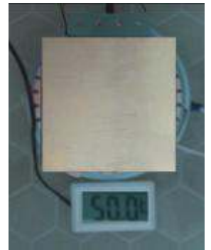
圖 36、散熱模組置於環控箱中以照熱系統測試散熱能力
