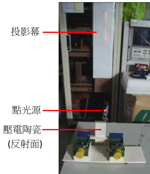
圖 13、觀測振幅的光學放大系統正視圖
