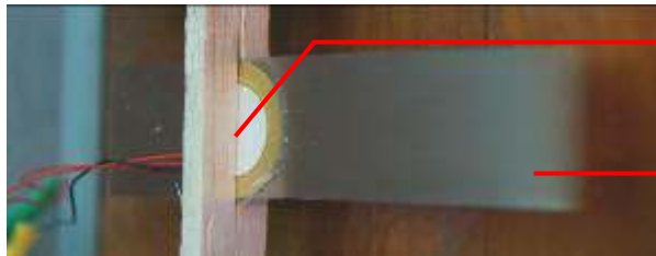
圖 6、蜂鳴片懸臂樑葉扇振動情形
