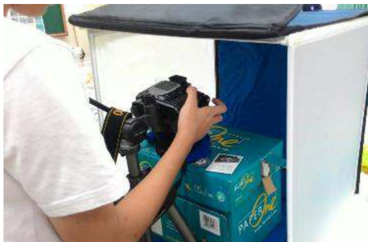
圖 4:紙箱改裝的暗室
