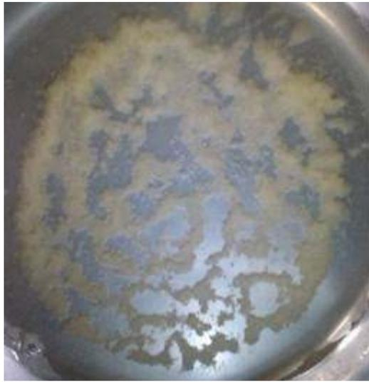
圖九、同一流體中各部份具有不同厚度的對流圖形
