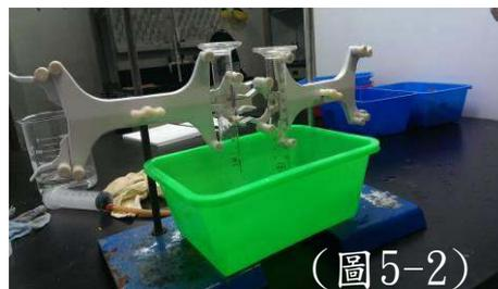
1. 將量筒改成滴定管，並在滴定管口以止水帶(因膠帶易被溶液侵蝕)纏繞上一漏斗，且在開關端上接一橡膠管藉以抽取氣體，手即可不必直接接觸溶液。
